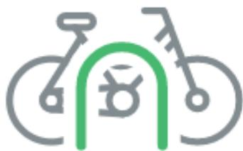
Figura 24: Paraciclo U invertido
